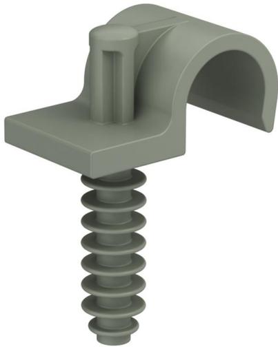
Ein Steckhaken für die Befestigung von einer Leitung bzw. Installationsrohr von 16 oder 20mm Durchmesser. Der Steckhaken kann mit der Hand ohne Werkzeug in ein 6mm Bohrloch gesteckt werden.
