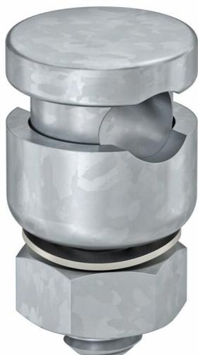
Raccord pour conducteurs ronds Ø8 à 10 mm. Vis prémontée , écrou , rondelle et patin de pression en acier galvanisé à chaud.
