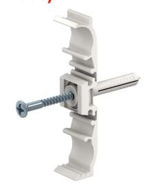
Schelle für die einfache, exakte, schnelle und sichere Befestigung von Kupferrohren, Stahlpanzerrohren DIN 49 020 und schweren Isolierrohren DIN 49 016 mittels Schlagmontage oder bei der Variante M6 durch aufdrehen auf ein M6 Gewinde ohne weitere Hilfsmittel.
