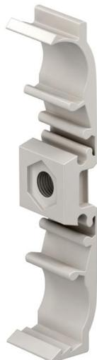
Schelle für die einfache, exakte, schnelle und sichere Befestigung von Kupferrohren, Stahlpanzerrohren DIN 49 020 und schweren Isolierrohren DIN 49 016 mittels Schlagmontage oder bei der Variante M6 durch aufdrehen auf ein M6 Gewinde ohne weitere Hilfsmittel.
