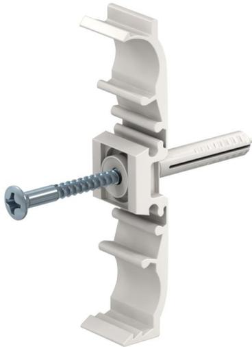
Schelle für die einfache, exakte, schnelle und sichere Befestigung von Kupferrohren, Stahlpanzerrohren DIN 49 020 und schweren Isolierrohren DIN 49 016 mittels Schlagmontage oder bei der Variante M6 durch aufdrehen auf ein M6 Gewinde ohne weitere Hilfsmittel.
