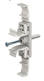
Schelle für die einfache, exakte, schnelle und sichere Befestigung von Kupferrohren, Stahlpanzerrohren DIN 49 020 und schweren Isolierrohren DIN 49 016 mittels Schlagmontage ohne weitere Hilfsmittel.
